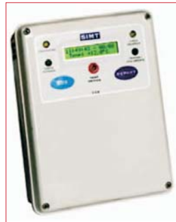
SIMT de Pablo Vargas. Es un sistema electrónico e informático de monitoreo remoto de cadena de frío en heladeras y/o cámaras frigoríficas, actualmente funcionando en farmacias de la provincia de Mendoza, las cuales han certificado las normas de calidad ISO 9002. Este sistema es monitoreado las 24 horas los 365 días del año para prevenir la interrupción de la cadena de frío de los productos.
