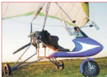
TRIKE LAIA de Ricardo Ramos. Es una aeronave de control pendular. En el carro van alojados los tripulantes y el motor, el cual va en la parte posterior en posición impulsora. El carro cuelga del ala como un péndulo siempre en la dirección de la gravedad parente.
